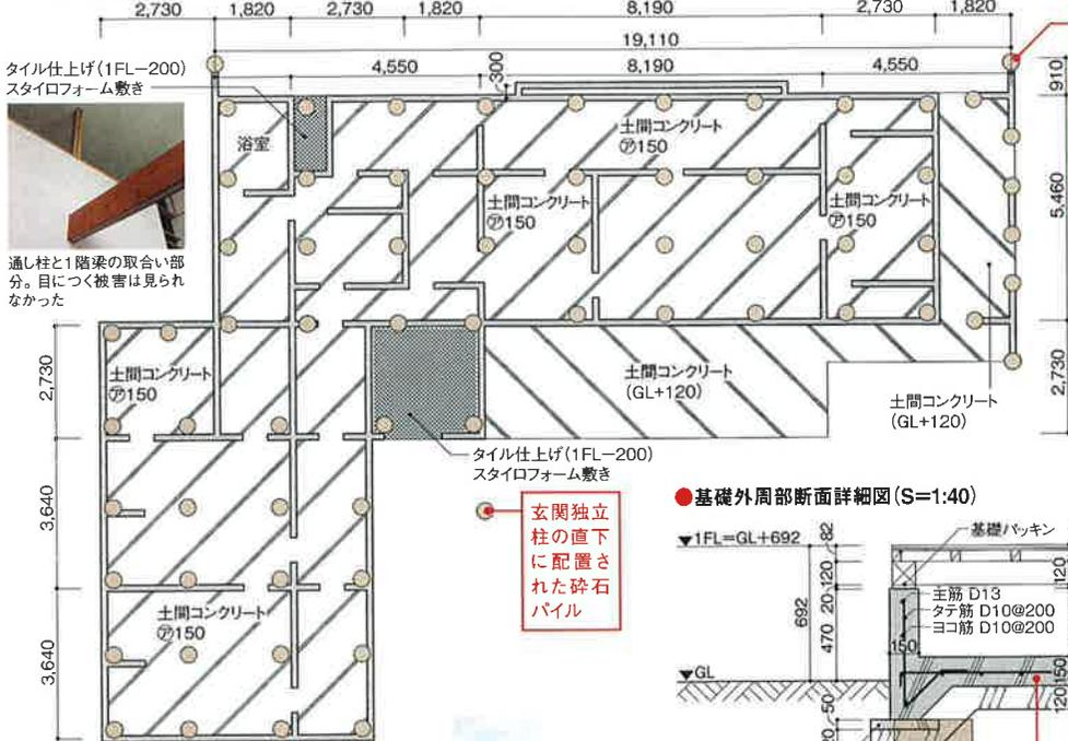
打設された砕石パイルの数は1階床面積177㎡に対して69本。主に基礎立上り部分に重なり合うように配置されている。施工費用は105万円
